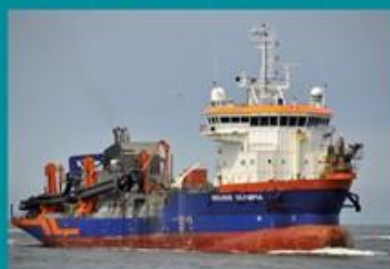
1 (uma) draga autotransportadora tipo Hopper (TSHD) "Volvox Olympia".
