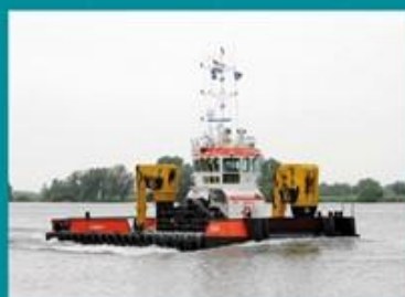
1 (um) Rebocador com lâmina de arrasto - Ploughboat "Yogi".
